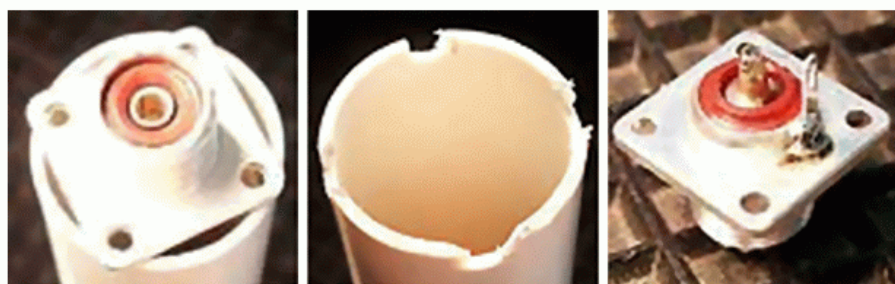
Obr. 3 - Montáž konektora SO239
